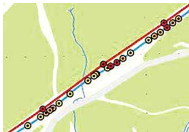
Hình 10. Đặc trưng kết quả khảo sát hiện trường so sánh giữa MMM và ILI (đường đỏ) [13]
